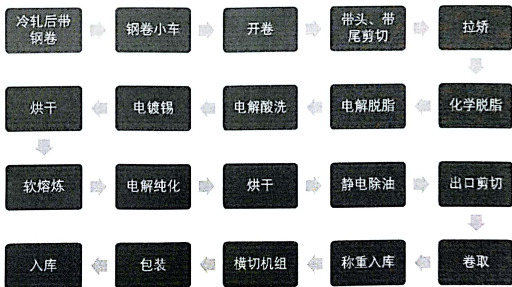
图 2 镀锡薄板的生产工艺流程
